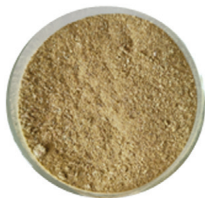
Rys. 1. Chmiel odpadowy z procesu ekstrakcji nadkrytycznym CO 2
